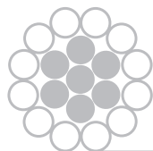
Tabulka G.2 Vlastnosti doporučených vodičů pro venkovní vedení s napětím nad 45 kV AC – Typ AL1/ST6C
